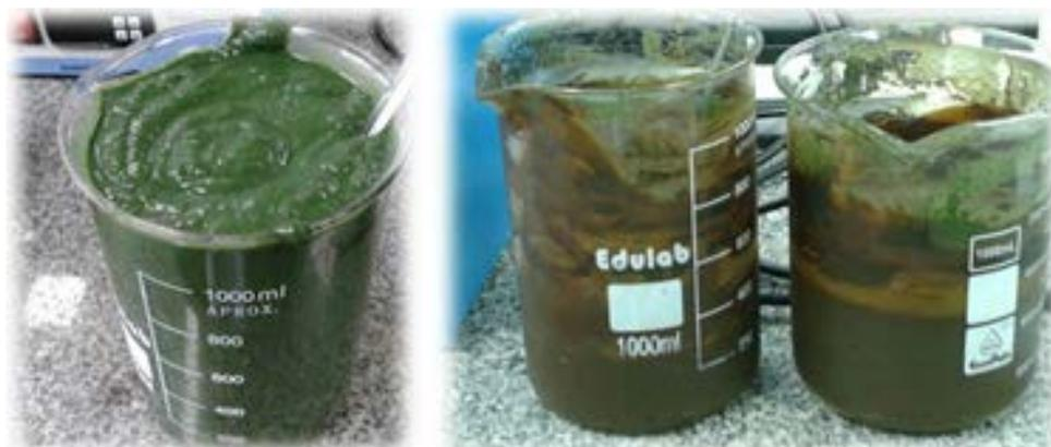
Figura 4: Biomassa bruta (a) e após processo hidrolítico térmico, apresentando coloração castanha (b).
